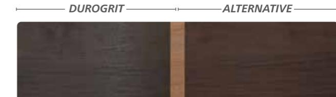
L'échantillon en bois **avant le test de frottement**. Il a été traité avec la couleur DuroGrit Charred Black sur la gauche et avec un produit alternatif de couleur similaire sur la droite.
